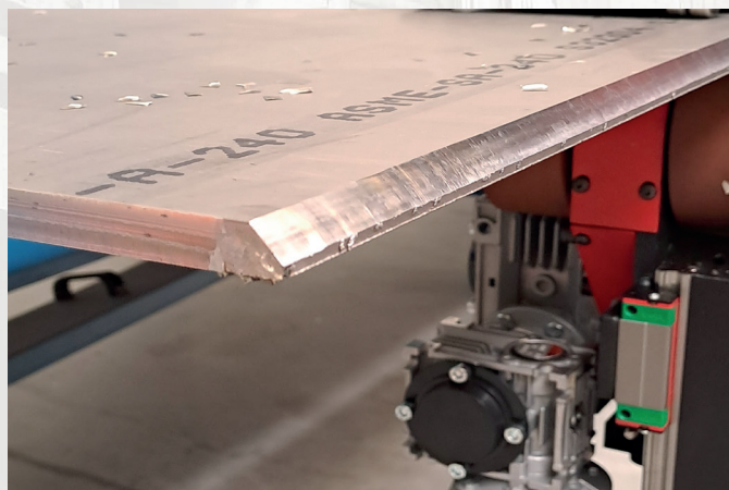
Ukosowanie stali nierdzewnych
