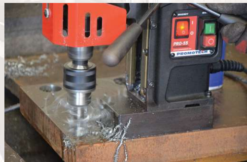
Wiercenie wiertłem do średnicy 16 mm
