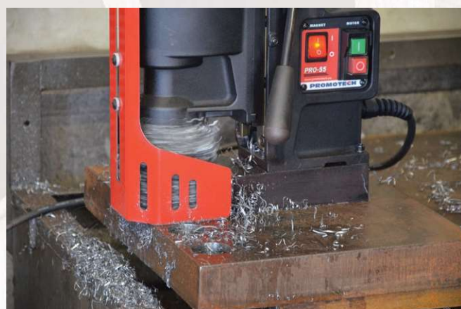
Wiercenie frezem do średnicy 55 mm na głębokość do 75 mm
