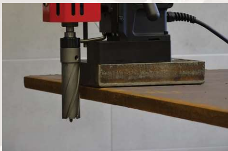
Wiercenie frezem TCT do średnicy 50 mm
