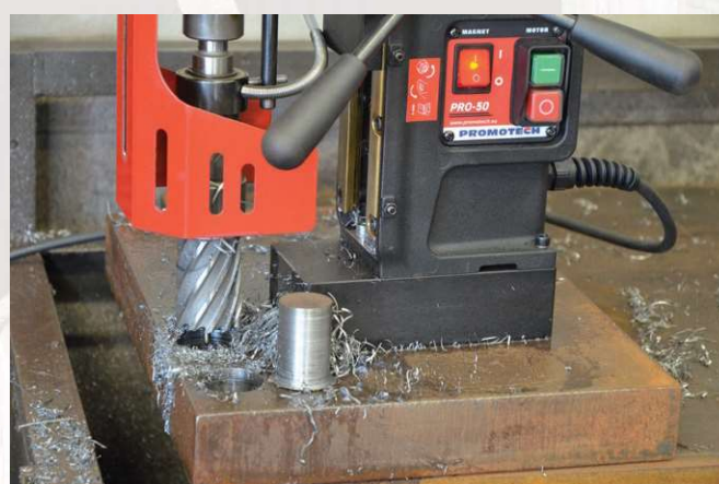
Wiercenie frezem do średnicy 50 mm na głębokość do 75 mm
