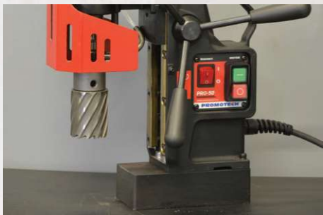
Wiercenie frezem HSS do średnicy 45 mm
