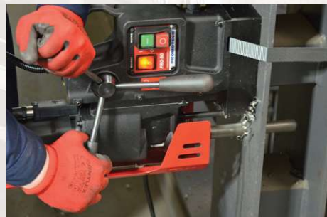
Wiercenie wiertłem do średnicy 36 mm
