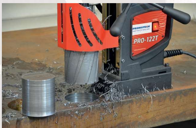
Wiercenie frezem na głębokość 100 mm
