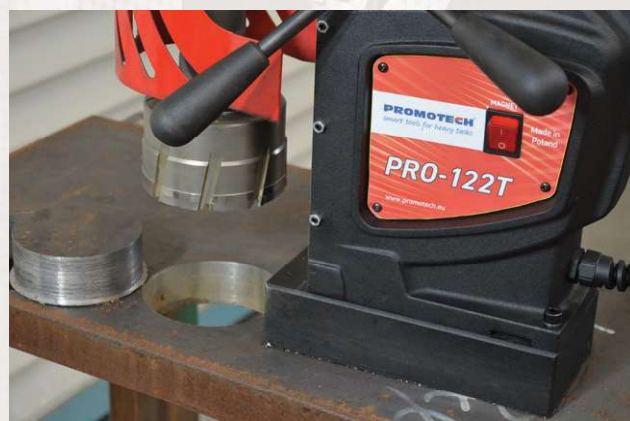
Wiercenie frezem do średnicy 120 mm
